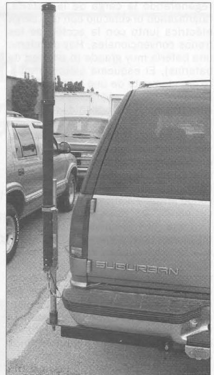
Foto 6. Una gran antena requiere un sistema de soporte resistente. Este está unido al arnés de remolque.
