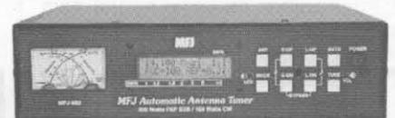
Este acoplador le permite la sintonía automática y muy rápida de su antena, el margen de ajuste es de 6 a 1600Ohm 300W PEP 150W CW.
