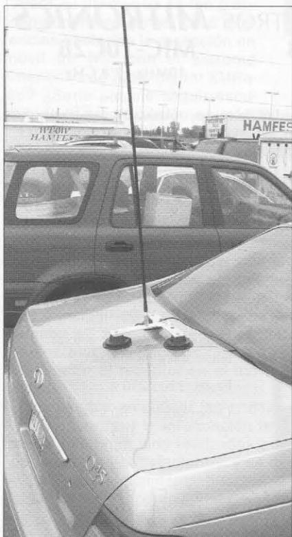
Foto 3. Una simple base magnética y una antena de látigo pueden hacer un buen trabajo.
