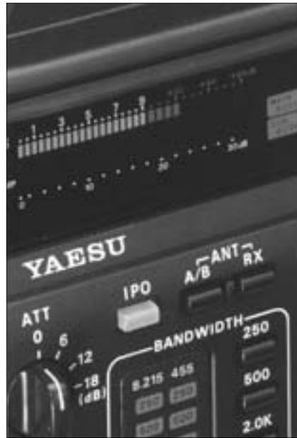
Foto A. Los mandos IPO/AIP/RF PREAMP y ATT permiten adecuar la sensibilidad general del transceptor a las condiciones del momento en la banda. Son excelentes ayudas para comunicaciones DX de señal débil. Hay que recordar hacer uso de la mínima ganancia/sensibilidad para evitar sobrecargas y el ruido adicional que se generan cuando los niveles de señal son elevados.
