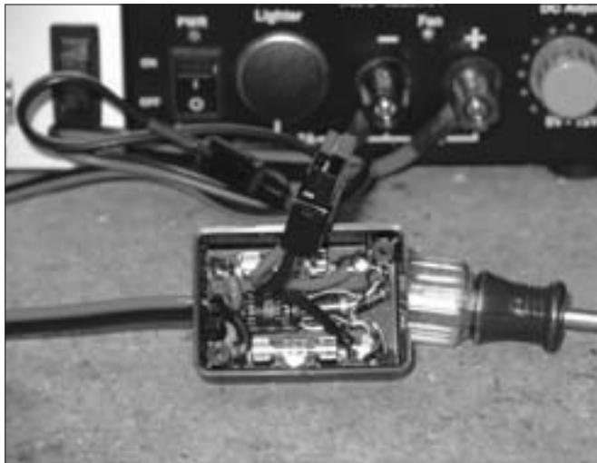
Foto A. Vista del alambrado interno del acondicionador de alimentación. Los conectores PowerPole de Anderson han sido retirados de su alojamiento para permitir ver mejor la disposición de los componentes.
