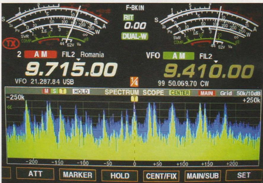
Foto E. Vista de la pantalla del receptor explorando la banda de radiodifusión de 31 metros. El margen mostrado va de 9,465 a 9,965 MHz. ¡Muchas señales a escuchar ahí!
