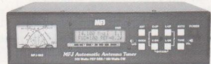
Este acoplador le permite la sintonía automática
