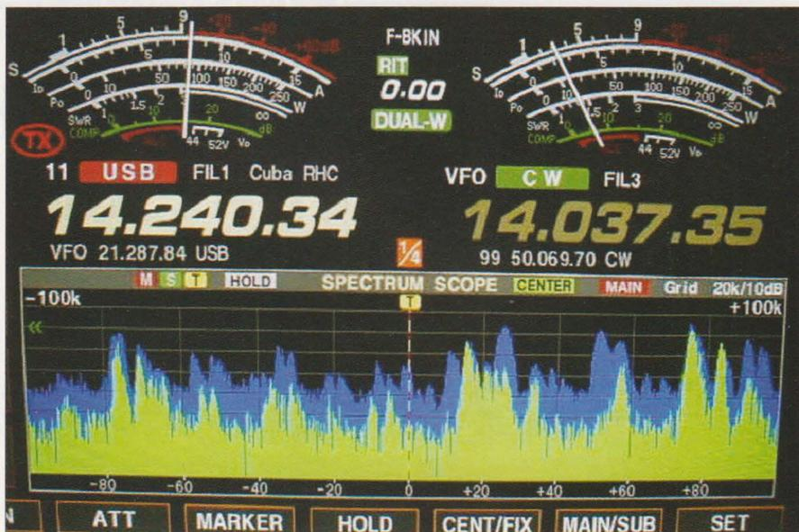
Foto D. Toma de la pantalla del IC-7800 con las señales de 20 metros captadas con la antena CHA250B. El margen mostrado va de 14,140 a 14,340 MHz. Pueden observarse gran número de señales fuertes a lo ancho de toda la banda.
