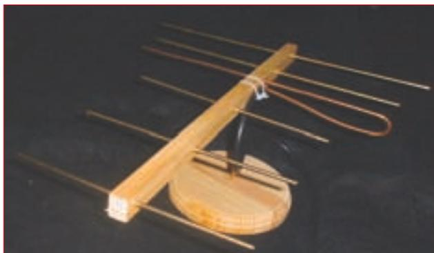
Foto E. Antena para TDT (HDTV) de construcción casera.
