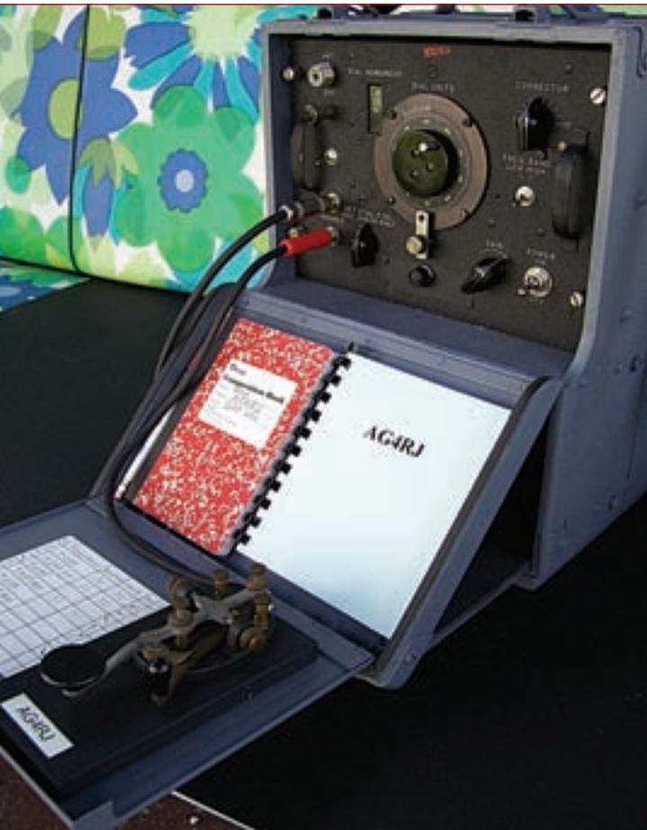
Foto A. Parece el equipo de radio de un espía de la Segunda Guerra Mundial, pero es realmente un transceptor QRP para 40 metros. Montado por Russ, AG4RJ, en la caja de un antiguo generador de señal. Montar equipos divertidos como éste continúa siendo uno de los grandes atractivos del QRP. ¡Vaya juguete!
