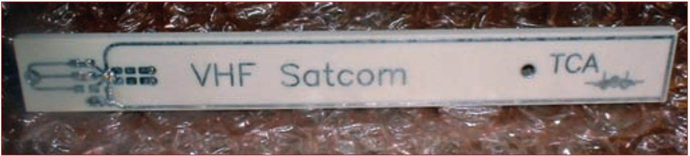
Foto C. Antena integrada de 2 metros en placa de circuito impreso.
