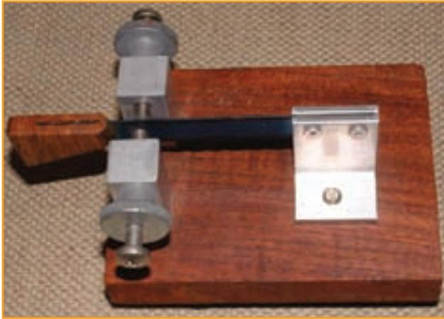
Foto 1. Uno de los más afinados y auténticos ejemplos de genuino manipulador "de hoja de sierra" es éste modelo sueco "Kungsimport", fabricado durante la década de los 80. Nótese la base de madera, los dos ángulos de fijación de la noble hoja de sierra (¡con sus dientes intactos!) y la empuñadura de madera. ¡Vaya pieza cautivadora! (Foto cortesía de Kungsimport vía N1EA)
