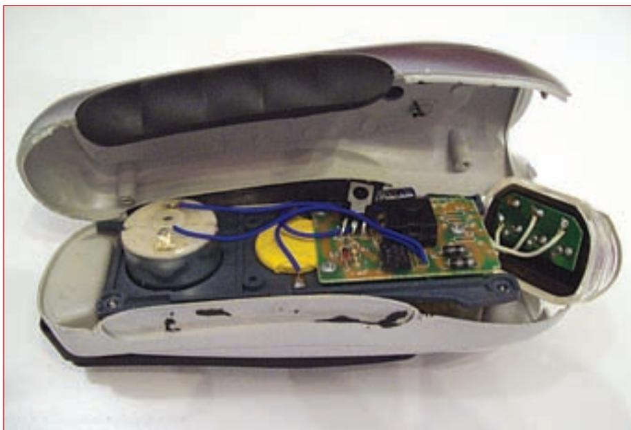
Foto D. Un vistazo al interior de esta linterna LED propulsada por una palanca revela que ésta se engrana a un pequeño motor de coche de “scaléxtric” que se utiliza como generador y recarga una pila de litio con forma de moneda cerca del centro. Un simple integrado regulador de una placa de PC descartado evita la sobrecarga y la corriente de descarga. La linterna es una buena fuente de alimentación para un equipo QRP (véase el texto).
