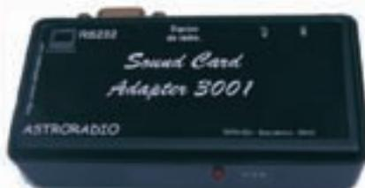
El Sound card adapter 3001 USB es un adaptador de tarjeta de sonido, para comunicaciones digitales de bajo costo, incluye todos los cables de conexión. Adaptable a todos los equipos del
