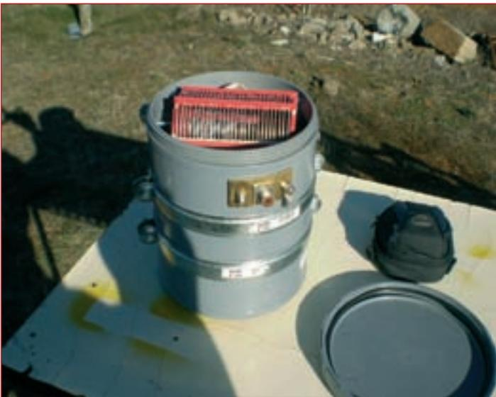
tro. Después de ajustar la inductancia con la ayuda del analizador de antena, quedó fijada en 1.910 MHz con una R.O.E de 1:1 y un ancho de banda de unos 40 KHz para una ROE menor de 2:1.
