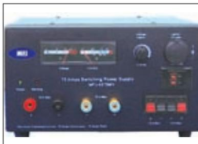
Foto C Fuente de alimentación conmutada MFJ-4275MV, capaz de entregar 75 amperios de pico y 70 amperios continuos, con un peso de tan sólo 4,7 kilogramos.
