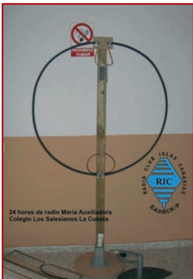
Foto B. Una antena de aro para las bandas decamétricas, como la de la foto, puede mejorar notablemente la recepción de señales en condiciones difíciles por ruido u QRM. (Nota: La señal de prohibición de fumar no tiene relación con la antena, Hi!)
