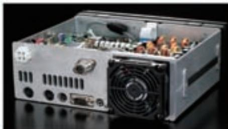
Chasis en fundición de aluminio con ventilador
