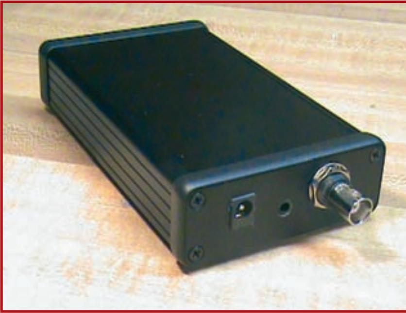
Foto C. El LD-1A es un receptor de cobertura general definido por software, controlado por un puerto USB, que cubre el espectro entre 500 kHz y 30 MHz.
