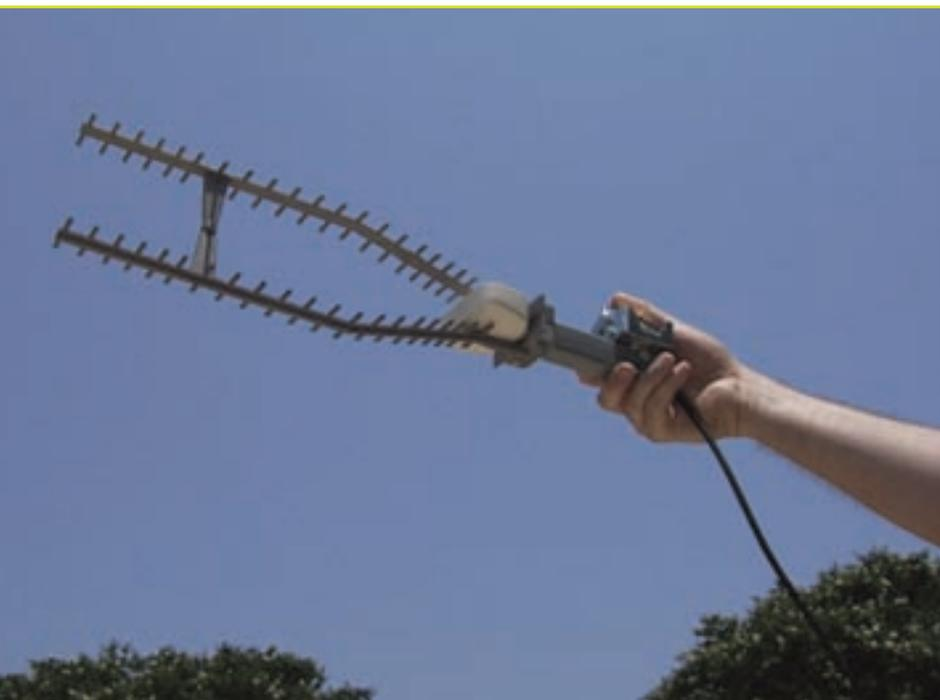
Foto A. Un moderno diseño para enlaces digitales a 2,4 GHz con dos antenas Yagi apiladas. Observa el elemento excitado común a ambas antenas.
