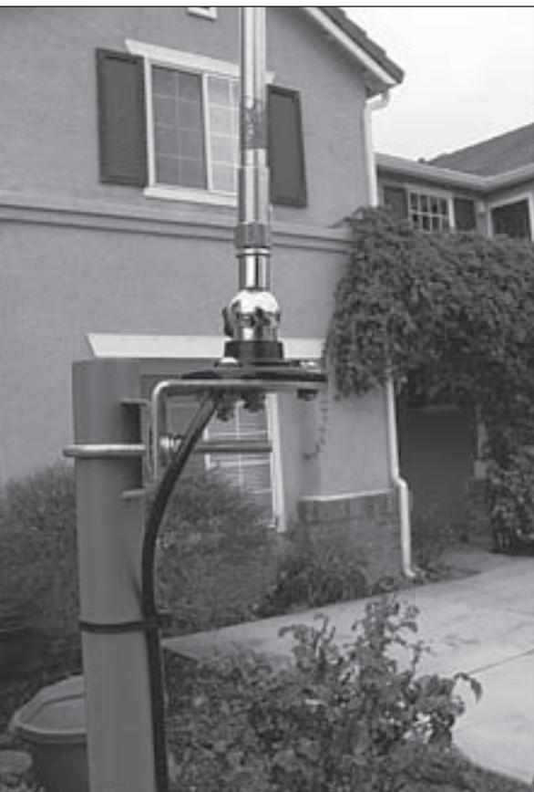
Foto E. Aquí vemos la antena Dino-Mite de Mike y Ernie, WA6OUW y N6HN, montada en su soporte y fácil de montar. Es muy fácil de construir mediante las piezas de una antena Hustler para móvil, tal como se describe en el texto. (Foto cedida por WA6OUW).
