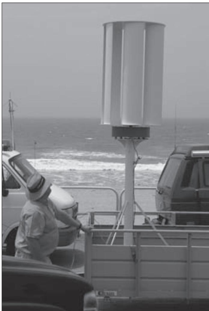
Foto B. Los generadores eólicos son también una buena fuente de energía. El nuevo diseño VAWT es vertical, silencioso y elimina las palas.
