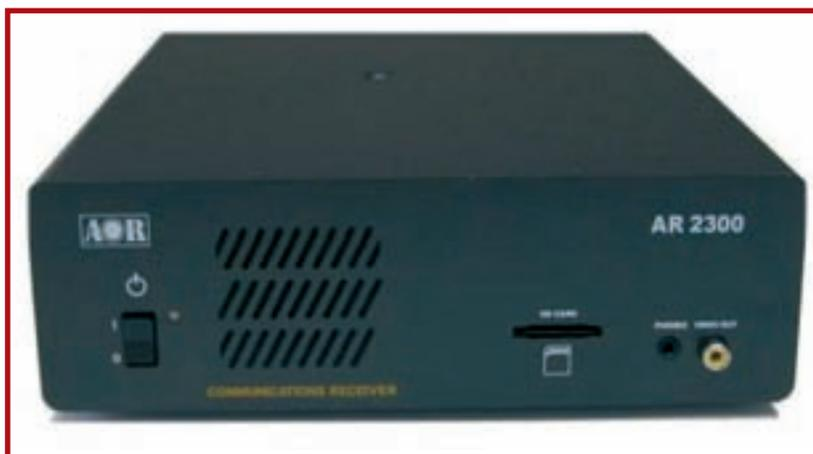
Foto A. Nuevo receptor AR-2300 de AOR, controlado por ordenador. Cubre desde 40 kHz hasta 3.150 MHz.
