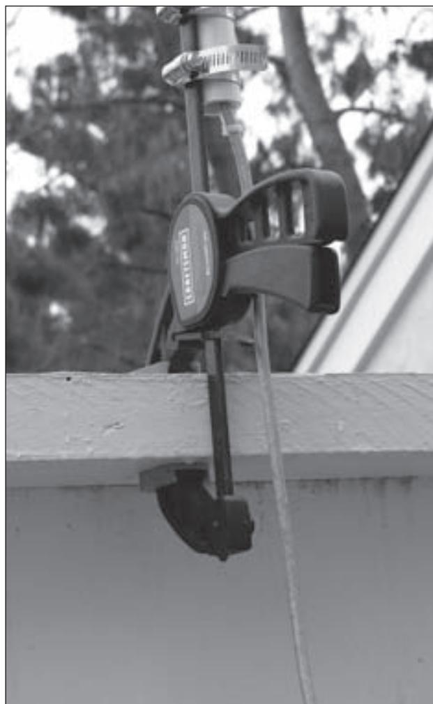
Foto F. El mástil de PVC se sujeta fácilmente a un sargento de carpintero colocado en cualquier superficie horizontal o reborde.
