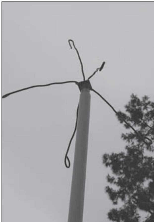
Foto E. Una vertical GP plegable es algo muy útil en un kit de emergencia transportable. Hazte una para cada banda en la que operes.
