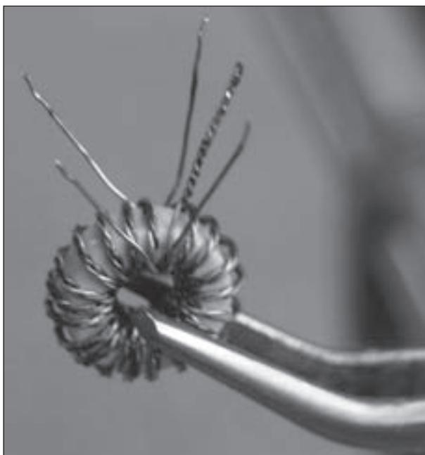
Foto D. Aquí tienes preparado un transformador T1 para el Gnat después de haber dado 20 vueltas del hilo en trifilar para 80 metros. Los extremos del secundario están a la izquierda y, a la derecha, la toma central y los otros dos extremos del primario.
