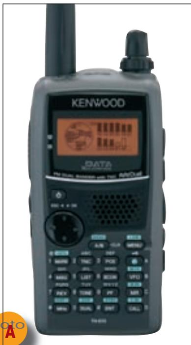
Entre el resto de prestaciones se encuentran: 1000 canales de memoria, *firmware* para APRS, puerto USB-Mini, software MCP-4A para conversión de datos de posición a ficheros KML (Google Earth, etc.), compatibilidad con sistema Sky Command II de Kenwood para control remoto de transceptores de la serie TS-2000, memoria para EchoLink, TNC de 1200/9600 baudios compatible con AX.25 (radiopaquete, etc.), función de repetidor digital, etc.
