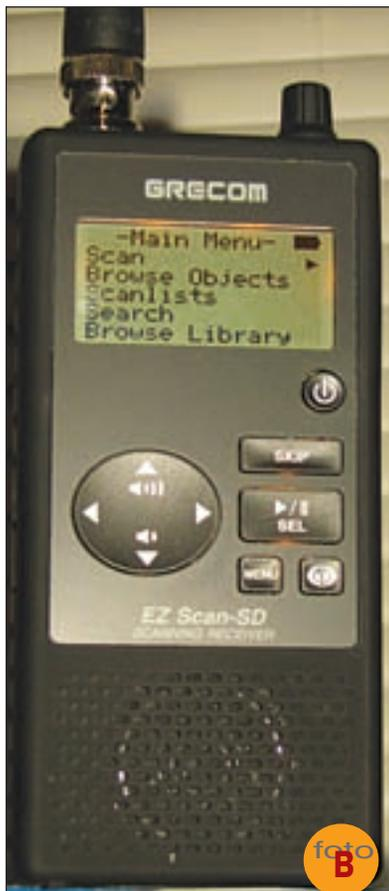
da estrecha. Incluye una tarjeta SD de 2 GB para almacenar la configuración de usuario, decodificador de tonos CTCSS y DCS, y puerto USB para conexión a ordenador para actualización de software. Dispone de una función denominada Spectrum Sweeper que permite localizar rápidamente señales cercanas aunque se desconozca su frecuencia. Para más información visitar el sitio web <http://www.greamerica.com> y clicar en Radio Scanner Receivers.
