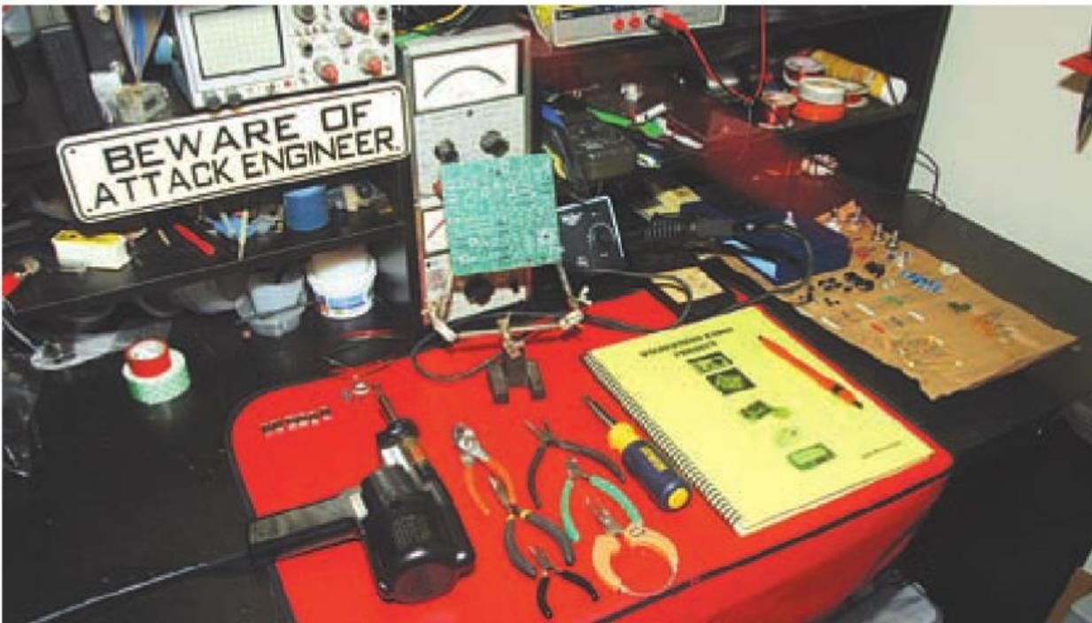
Foto C. Banco de trabajo del autor. Está bastante limpio, lo que significa que no estaba montando nada (puede distinguirse la madera de la mesa). El mantel rojo es una superficie antiestática que utilizo para evitar dañar los componentes con mi electricidad estática. Las herramientas están todas al alcance la mano y el manual amarillo a la derecha es el de montaje del NC-40A. La pistola de la izquierda en primer plano es un desoldador para reemplazar los componentes erróneos o averiados.
