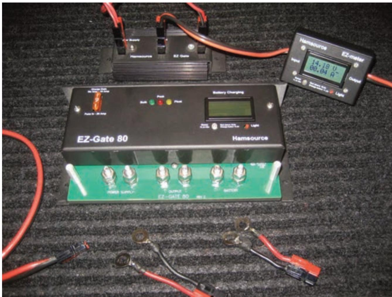
Foto D: El nuevo distribuidor de corriente EZGate 80 de HamSource en el banco de pruebas.
