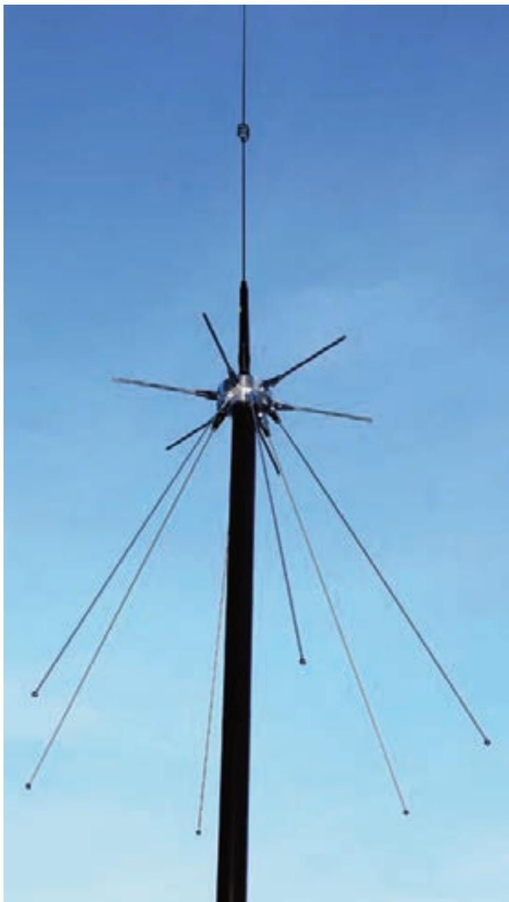
Foto A: Una de las configuraciones de antenas posibles usando la base de antenas Alpha Node Antenna Hub (foto cedida por Alpha Node).
