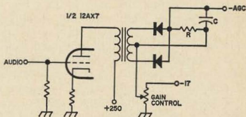
Fig. 7. The AGC circuit.
