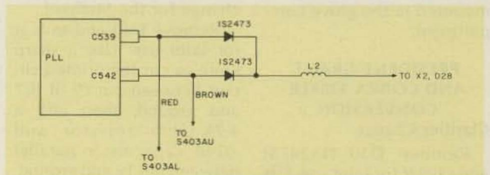
Fig. 9. PLL wiring for LSB.
