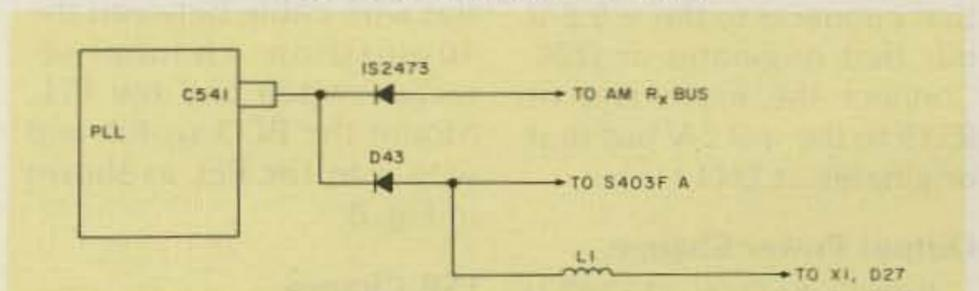
Fig. 10. PLL wiring for AM.
