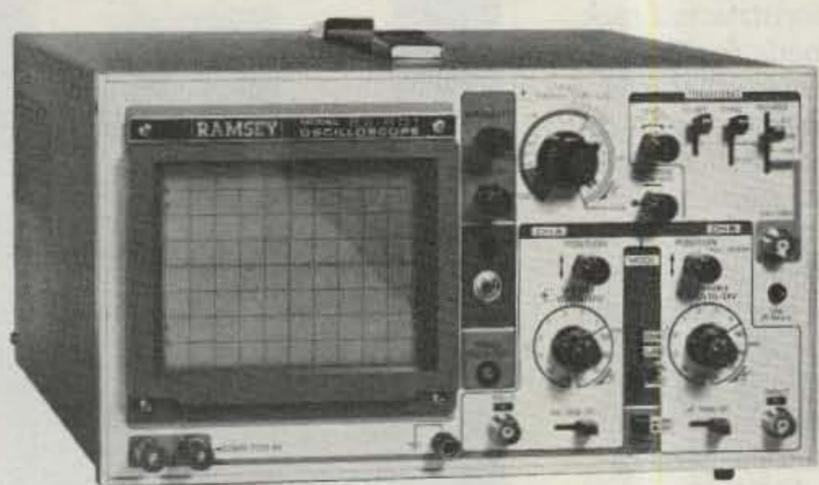
**20 MHz DUAL TRACE OSCILLOSCOPE**
