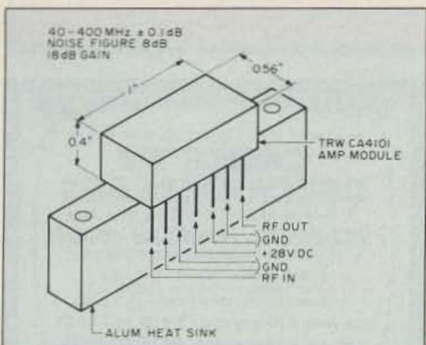
Figure 4. TRW CATV amplifier module.
