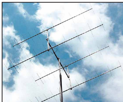
K3TV's 2 meter antenna system—four 12-element M 2 Yagis.
