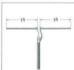
Figura 6.— Para eliminar las ondas estacionarias en una antena dipolo, admitida que la salida del transmisor disponga de una impedancia de salida similar a la del cable coaxial, bastará con acortar o alargar los dos extremos. La longitud de ambos extremos, para este tipo de antena, deberá resultar, entre ambos, de 1/4 de onda.
