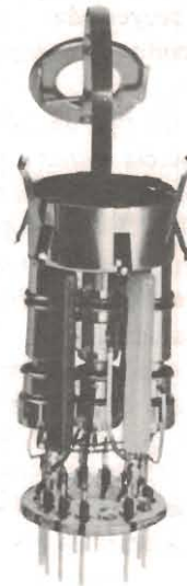
Figura 3.2. Conjunto de cañones electrónicos de un tubo de imagen 20AX.
