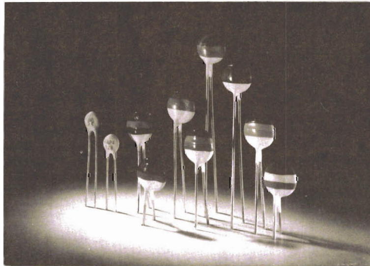
Figura 6. Varistores de óxido de zinc para supresión de transitorios.
