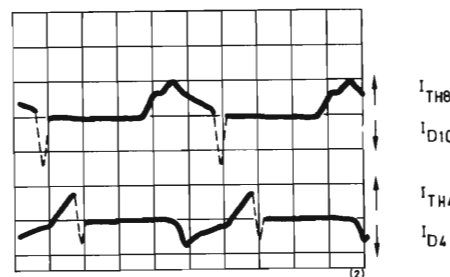
Oscilograma 2. 200 \mu s/div , 100 A/div .
