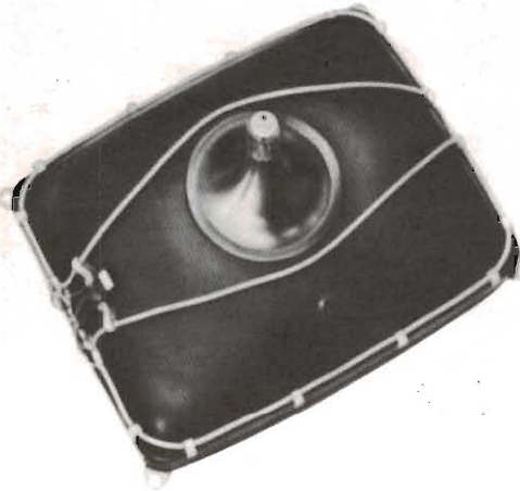
Figura 3.6. Posición recomendada de las bobinas de desimanciación en un tubo de imagen 20AX.
