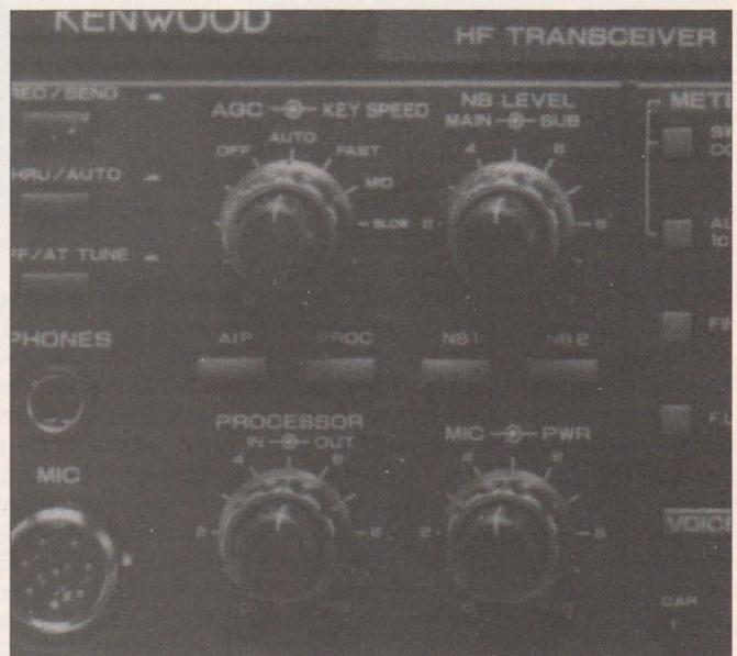
Dos limitadores de ruido con control variable de nivel, manipulador interno de CW y mando de ajuste de AGC son algunas de las varias facilidades de este transceptor.
