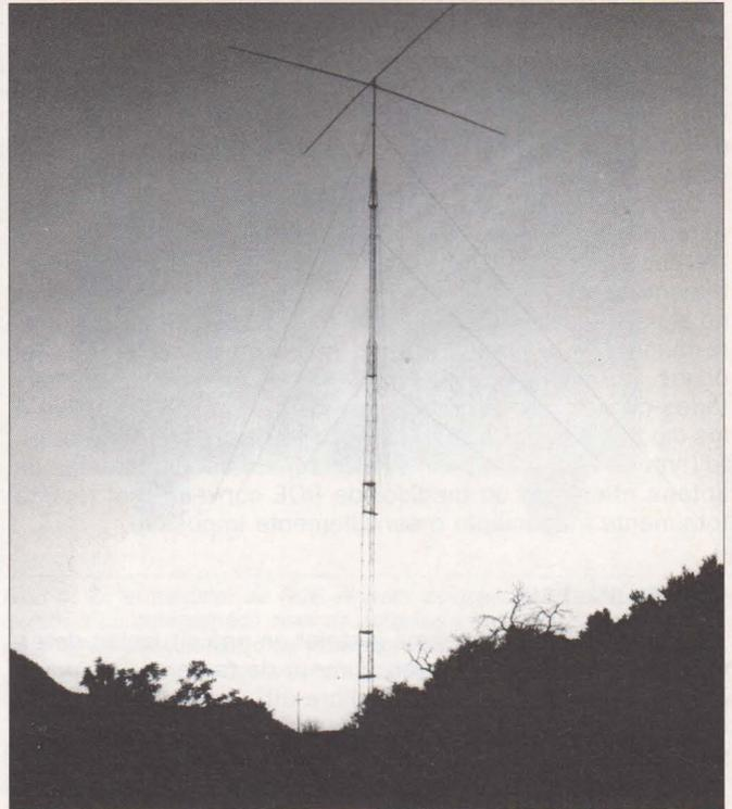
Foto 5. Antena vertical con plano de tierra para la banda de 160 metros, dotada de una carga capacitiva superior (E6A6AC).
