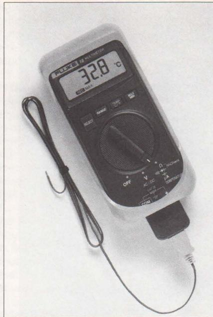
Tester digital Fluke automático y termómetro.
