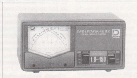
Foto 3. Las dos agujas de este vatímetro direccional indican la potencia directa y la reflejada y en el punto de cruce de ambas se lee la ROE.
