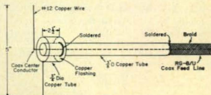
Fig. 1—Corner Reflector Feeder.
