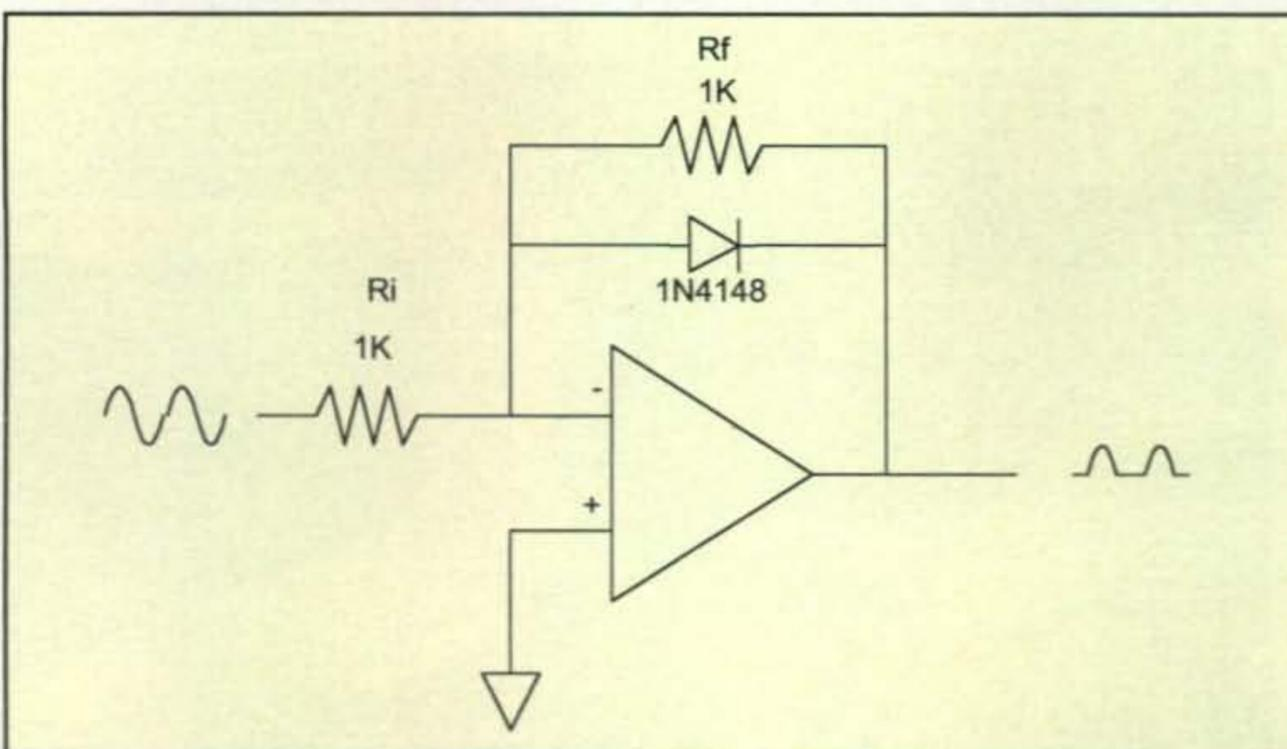
Fig. 5— Non-diode precision rectifier.
