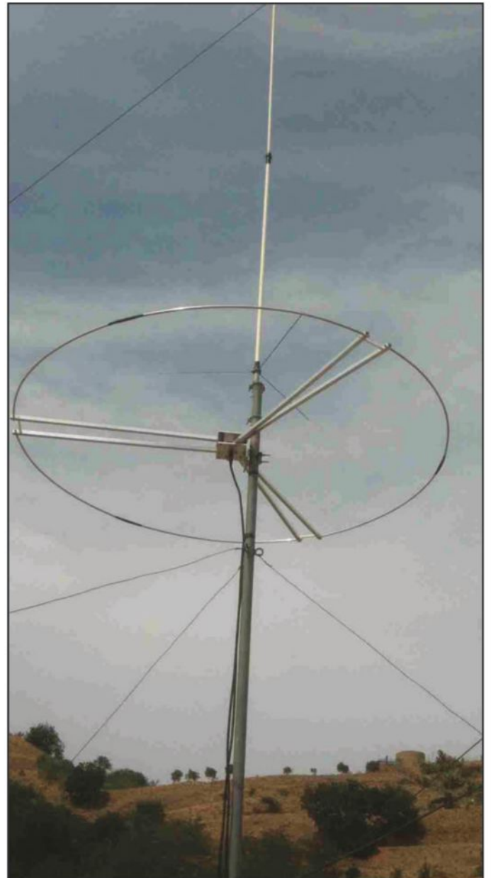
Photo C. IW9GDC/B 70-MHz beacon antenna. (Courtesy of IW9GDC.)
