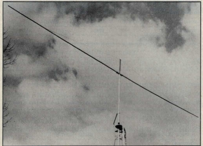
La antena HR-5 de cinco bandas instalada en la parte superior de la torre.
