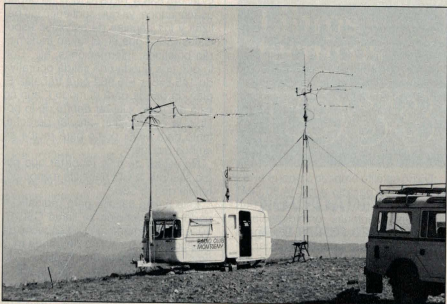
La estación ED3RCM y sus antenas. Izquierda: antena para 144 MHz, 1,3 kW, 3 x 16 elementos, preamplificador de GaAs/FET 3SK97, con un factor de ruido (NIF) de 0,7 dB. Centro: antena para 1.296 MHz, 3 W, 8 x 16 elementos. Derecha: antena para 432 MHz, 100 W, 4 x 21 elementos, GaAs/FET 3SK97, factor de ruido de 0,9 dB.
