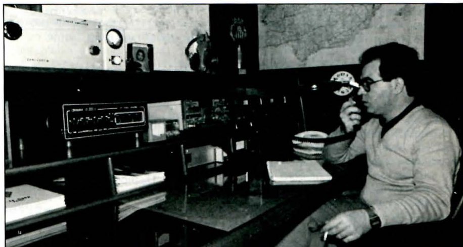
EA5CVD, Jacinto, produce una potentísima señal desde Valencia capital, tanto en 432 MHz como en 144 MHz. Equipos en 144 MHz: Yaesu FT-255RD modificado más Icom 251 E; lineales 1 x 4CX350A y 2 x 4CX250B. En 432 MHz Icom 451 E.
