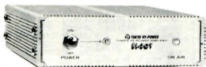
HL - 30v 144 - 148MHZ (150 - 160) FM - SSB Entrada 0,5 - 5W - Salida 35W
