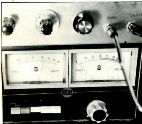
Con un medidor de potencia, se aprecian unos 5 vatios efectivos de salida. Si la ROE es alta, esta lectura quedaría falseada, y en lugar de antena debería utilizarse una antena fantasma.
