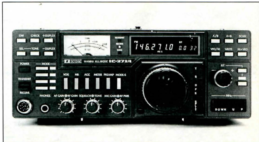
Figura 1. Vista frontal del ICOM IC-271A. El diseño es atractivo y funcional, con numerosos mandos para disfrute de posibles usuarios.
