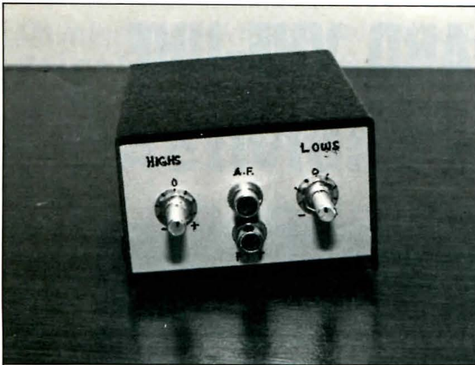
Vista posterior del ecualizador. Se pueden incluir mandos en los ejes de los potenciómetros de control de tono.
