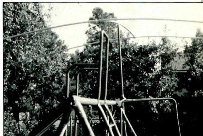
Antena directiva de N4HCR, instalada provisionalmente en torretacolumpio, para efectuar pruebas y ajustes iniciales.
