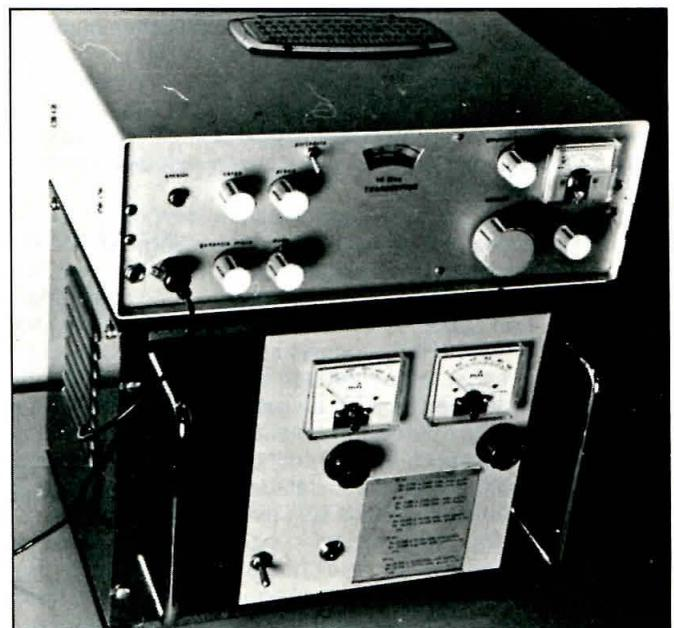
Figura 7. Amplificador lineal rēja a masa, que permite pasar la baja potencia de un equipo QRP a una potencia entre 100 y 250 W.
