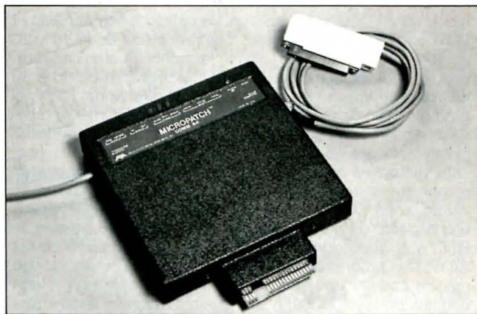
Micropatch, uno de los muchos adaptadores o interfaces entre el transceptor y el ordenador personal. Esta unidad permite conexión directa con el ordenador Commodore 64, facilitando el trabajo en RTTY, CW y AMTOR. Los cambios de lenguaje y comprobación de datos se efectúan por programación (software).
