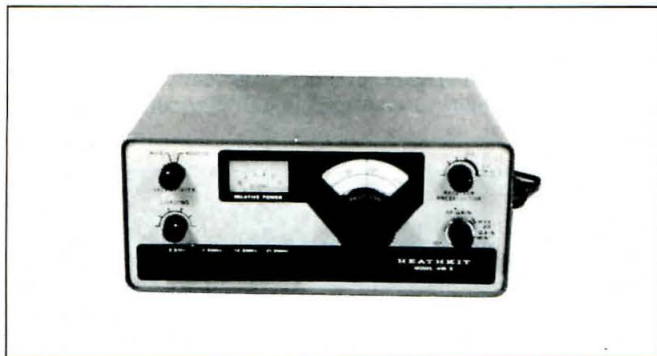
Transceptor Heathkit modelo HW-8 QRP de 2 vatios sólo para CW. Se suministra en kit.
