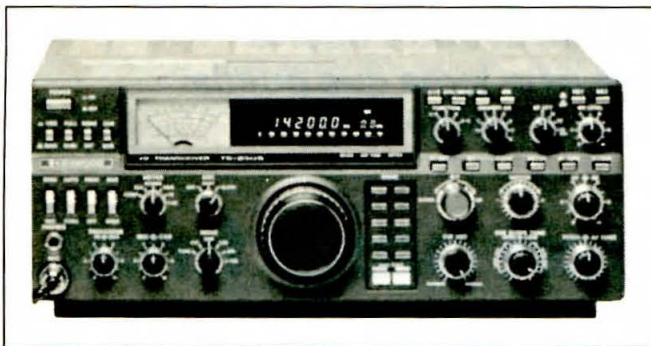
Figura 3. Transceptor Kenwood TS-930S. Los fabricantes hacen verdaderos esfuerzos para obtener equipos transistorizados con señales limpias de emisión. Este modelo podría entregar 500 vatios, pero se limita a unos 125 W efectivos de salida en beneficio de la pureza espectral de la señal emitida.
