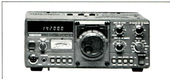
Figura 2. Transceptor Kenwood TS-130SE. El aspecto es el mismo que el del TS-120, pero en el TS-130 las protecciones impiden que los transistores del paso final puedan llegar a destruirse.
