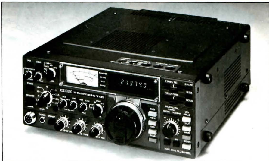
El transceptor IC-740 de Icom incluye doble OFV, una memoria por banda, diversos filtros antiinterferencia y un efectivo supresor de ruido. Puede alimentarse a 220 V directamente si se le incorpora la unidad opcional de alimentación, con lo que resulta el equipo más compacto para servicio fijo.
