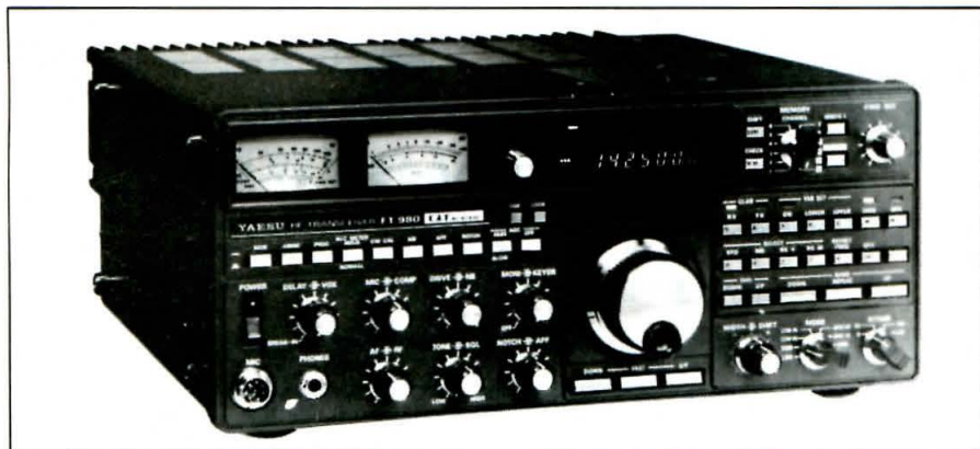
El FT-980 de Yaesu es uno de los transceptores con mayores prestaciones; posee gran cantidad de mandos, muchos de los cuales bastantes aficionados nunca llegarán a utilizar.
