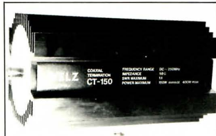
Figura 3. Carga Welz de 0 a 250 MHz, 150 W continuos y 400 W para ajustes rápidos.
