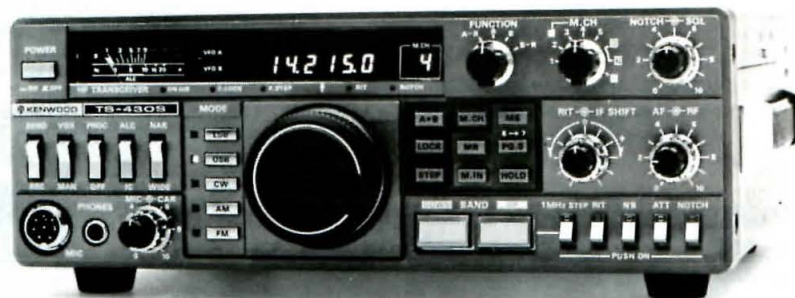
El transceptor TS-430S de Kenwood es una versión ampliada del popular modelo TS-130, permitiendo además una recepción continua.
