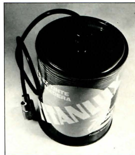
Figura 6. Aspecto final de la carga. Se ha utilizado un bote para blindaje exterior. De sumergirse en aceite la carga, posiblemente su potencia de disipación se triplicaría.
