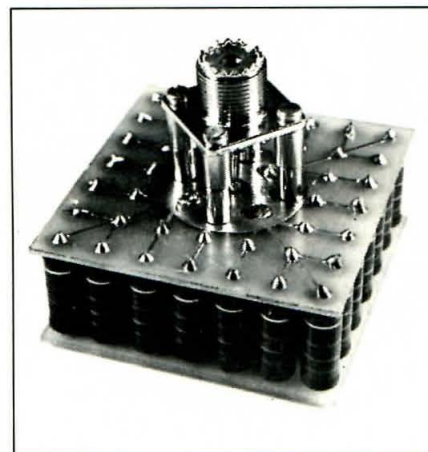
Figura 4. Carga ficticia de fácil realización. Sólo requiere un blindaje exterior.
