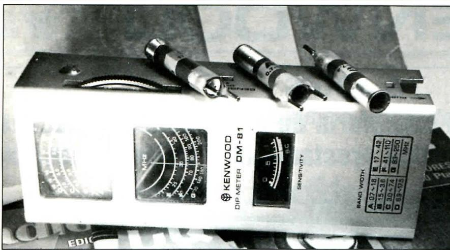
Figura 5. Un dip meter sencillo puede servir para calibrar el monitor de propagación.
