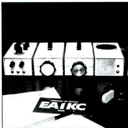
La miniestación de la fotografía consta de: 1) Manipulador electrónico más acoplador de antena. 2) Transceptor 14 MHz. 3) Transceptor 3,5 MHz. 4) Alimentación más altavoz.
