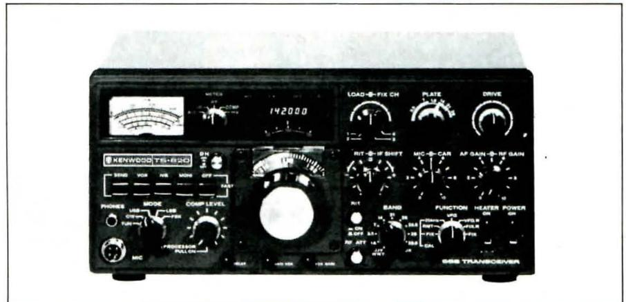
Transceptor TS-820 de Kenwood. Es un ejemplo de equipo con una sección frontal muy cuidada en cuanto a margen dinámico y sensibilidad y que puede encontrarse a buen precio en el mercado de ocasión.
