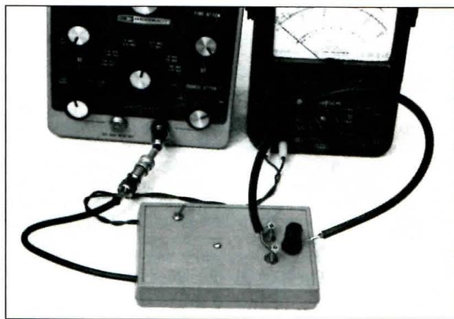
Detector de resonancia. Puede detectar la frecuencia de resonancia de circuitos sintonizados y líneas de transmisión desde 1 a 250 MHz.
