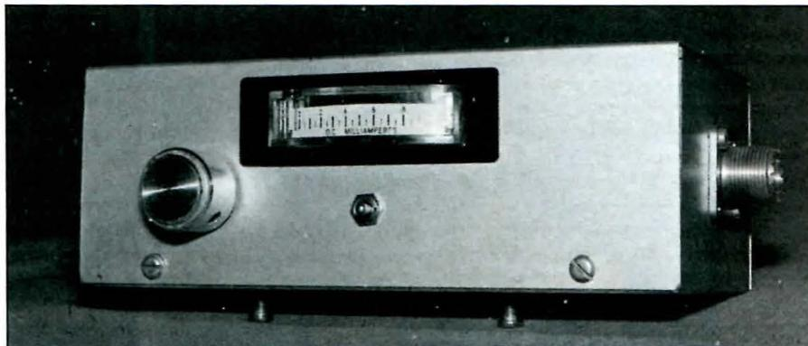
*Un medidor de ROE puede ser el inicio de otros muchos equipos de construcción propia. El medidor de ROE mostrado es útil hasta 1.000 W para HF y VHF.*
