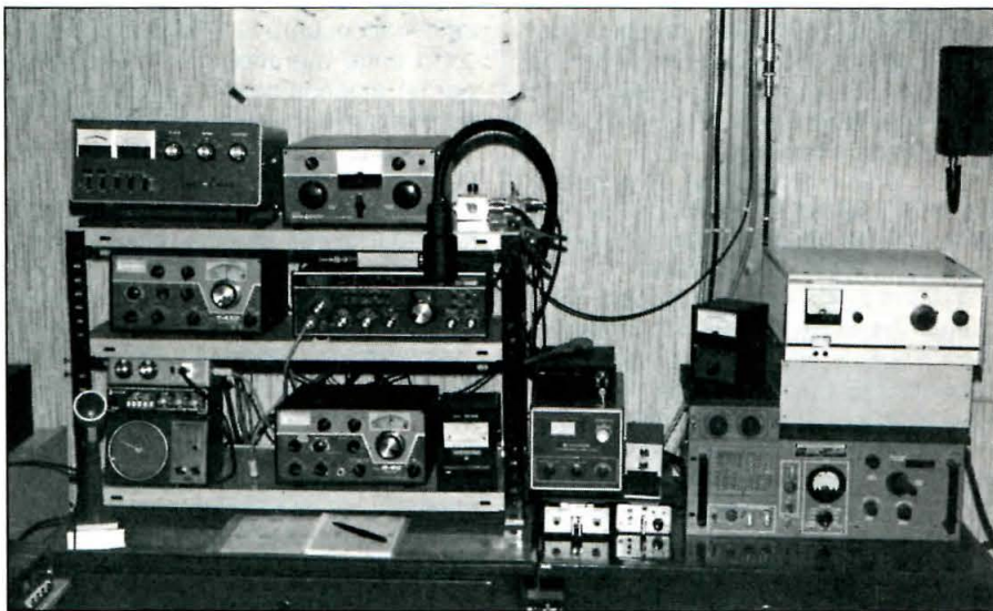
Equipamiento de DJ5MS: a la derecha el Tempo 2002 (1,5 W), a la izquierda del R4B el rotor de azimut y el filtro de audio Datong FL2, a la derecha del R4B el rotor de elevación, el TR7 y el «transverter» completan la estación.
