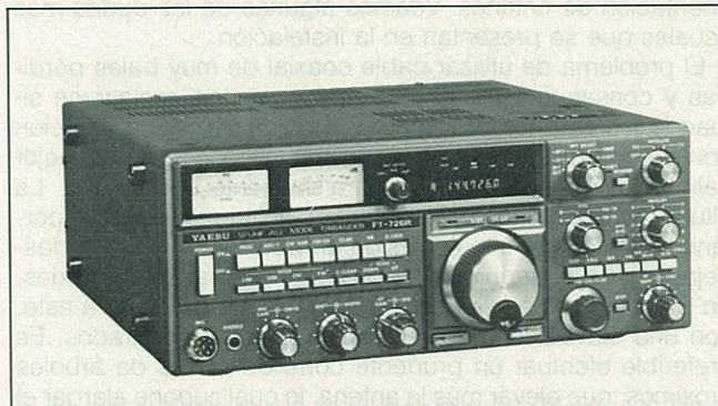
Transceptor Yaesu FT-726R con salida de 10 vatios, y todas las modalidades. Para trabajar el OSCAR 10 necesita instalar módulos opcionales para 70 cm y trabajo en duplex.
