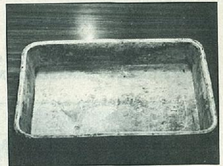
Figura 4. Una cubeta de fotógrafo sirve para verter el percloruro férrico y atacar las placas
