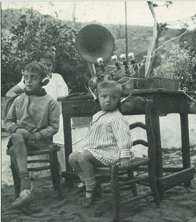
«Field day» o escuchando la radio en el campo en el verano de 1927. Son visibles las bobinas de antena, sintonía y reacción que el receptor llevaba en el exterior y que se podían deslizar mediante un mando de cremallera hasta hallar el punto óptimo de acoplamiento. El hermano del autor (q.e.p.d.) y a su lado el propio autor a los dos años de edad, con chupete y auriculares.
