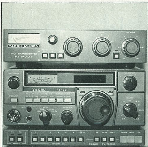
Panel frontal del transceptor FT-77. Puede apreciarse su diseño funcional y la escasez de florituras.
