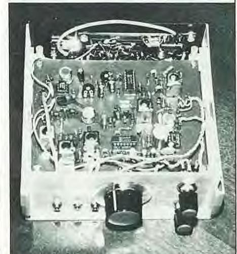
Figura 1. Aspecto frontal de un transceptor QRP de doble banda lateral (DBL) y sin la cubierta superior muestra la circuitería. Al fondo se observa el añadido amplificador de 2 W.
