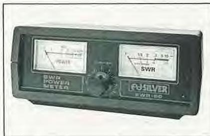
ondas estacionarias (instrumento de la derecha) y la potencia relativa de la señal que se envía a la antena transmisora (instrumento de la izquierda, «POWER»).
