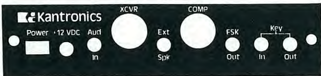
Figura 2. Panel posterior de una unidad terminal (TU) para RTTY con sus conectores.
