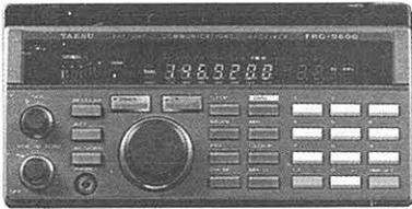
Opcionalmente puede llevar una frecuencia intermedia de TV (actualmente sólo disponible para el sistema americano), mediante la cual se pueden visualizar imágenes conectando un monitor al terminal de salida del vídeo. Incluye conexiones para grabación, altavoz exterior y una salida múltiple para decodificador de FM estéreo.
