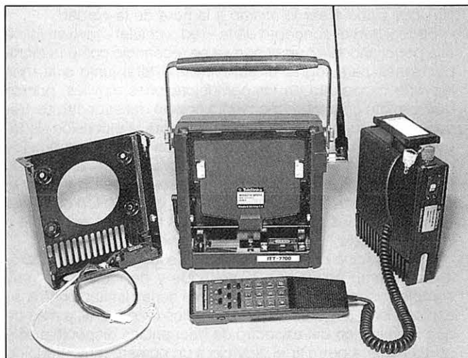
Figura 4. Equipo ITT-7700 para radio celular (banda 450/460 MHz).
