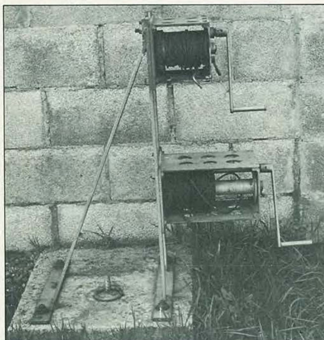
Vista de los cabrestantes con los cuales instalé el mástil y las transmisiones, también los empleo para abatir la segunda torre cuando tengo que efectuar algún trabajo de reparación o mantenimiento.
