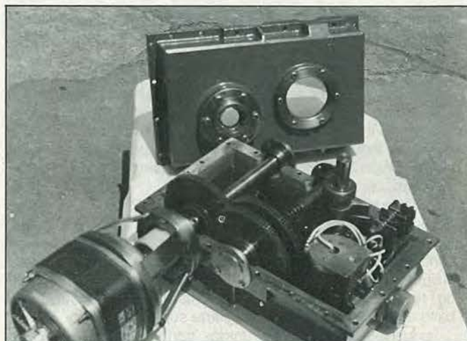
Caja reductora que mueve las antenas; en su interior están alojados los microinterruptores que cortan el final de carrera y el selsyn copiado.
