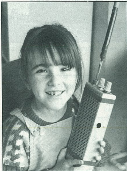
Helena nos muestra el aspecto del portátil de HF en el que se aprecia la corta varilla con su bobina de carga.
