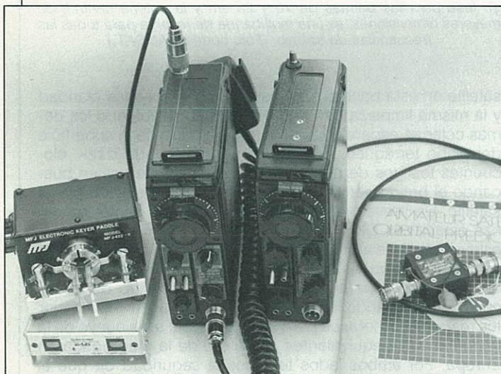
Figura 2. Una de las combinaciones más sencillas para trabajar vía OSCAR 10 en Modo B. Está constituida por un transceptor portátil de 2 metros para BLU/CW (Icom 202) complementado con un preamplificador a GaAsFET y por un segundo transceptor portátil (Icom 402) para la banda de 70 cm en BLU/CW que excita a un amplificador de potencia Encomm/Tokyo tipo HL32U de 20 W. Añadiendo las respectivas antes «twist» se obtiene un conjunto capaz de proporcionar comunicaciones con todo el mundo. (Se trata del equipo portable y de respuesto de K4TJW.)
