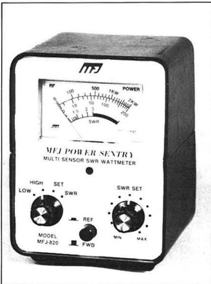
La ROE (SWR) es la característica o «parámetro» del sistema de antena que más comúnmente se somete a medida. Si bien la obtención de su lectura resulta muy fácil para cualquier radioaficionado, el resultado sólo indica una pequeña parte del comportamiento global de la antena. (Foto cortesía de MSF Enterprises).
