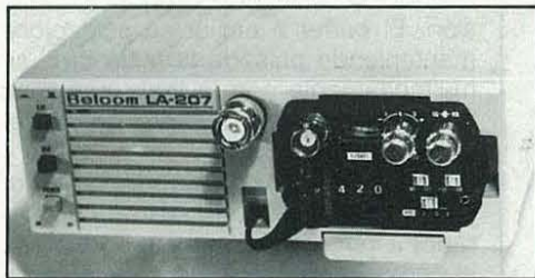
LA 207 AMPLIFICADOR de 25 Wts. de 140 A 170 Mcs
