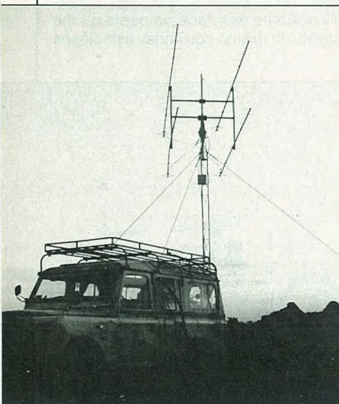
Formación 4 x 20 elementos para 432 MHz de EA3FD. Foto realizada durante su participación en el concurso del Mediterráneo de junio desde el pico de Salinas (JN12IK).
