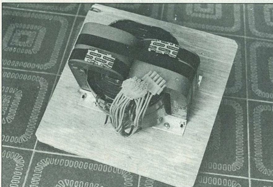
El transformador de red con sus más de 20 kg de peso, tal como viene de fábrica para su montaje en la fuente.
