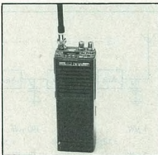
LS 210 140 - 170 Mcs CONTINUOS SELECCION POR RUEDAS 3 POTENCIAS DE SALIDA
