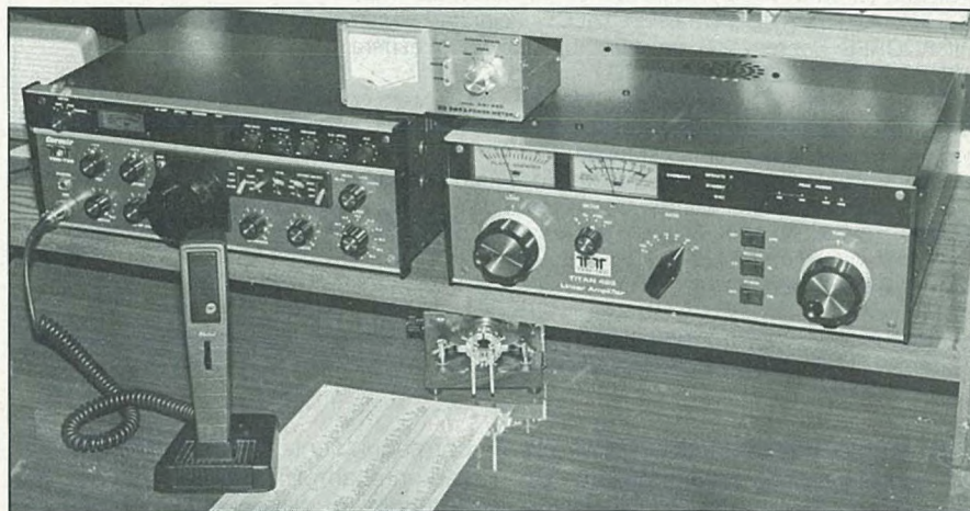
El amplificador Titan con el transceptor Corsair de compañero. Cuesta creer que una línea de 3 kW tenga casi el mismo tamaño que el transceptor que le excita.
