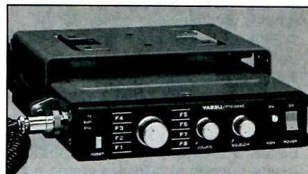
El aspecto exterior no cambia excepto en que el disipador es de una sola pieza de aluminio para mejor disipación de calor y el circuito ha sido cambiado por completo para permitir en una sola subbanda la cobertura completa de la banda VHF, manteniendo el ancho de banda usual de 10 MHz.
