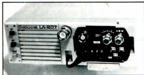
LA 207 AMPLIFICADOR de 25 Wts. de 140 A 170 Mcs
