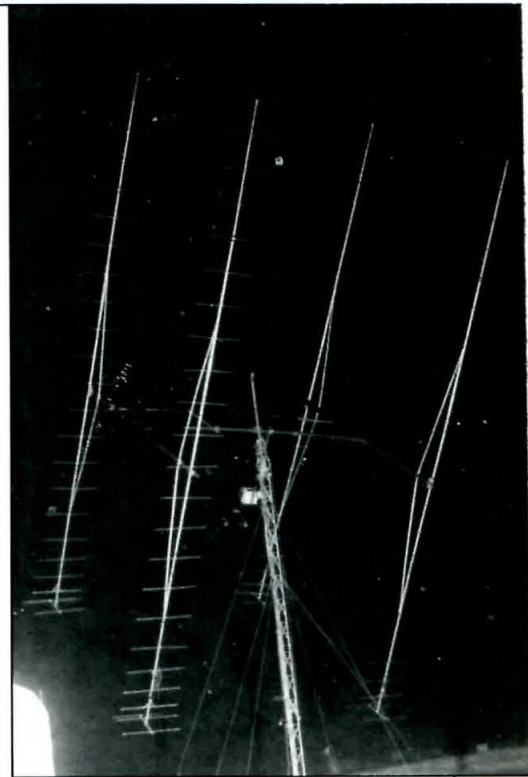
Antenas de EA3DXU durante su participación en el ARRL EME. Para que os ahorréis contarlos, hay 24 elementos en cada antena.
