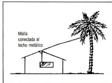
Dibujo ilustrativo de la colocación de los slopers. Tejado y palmera.
