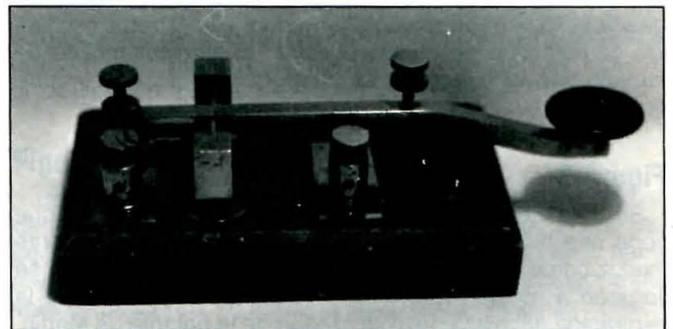
Figura 8. El «Cadillac» de los manipuladores para las estaciones de chispa. Se trata de un Clapp Eastham montado sobre una base de mármol. Tiene contactos de más de dos centímetros de diámetro, se fabricó en 1915 y pertenece a la colección de K6ARE.
