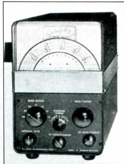
Figura 6. El modelo de receptor 1-A de R. L. Drake vino a significar un cambio radical en el aspecto de estos aparatos pero su calidad funcional pronto le convirtió en un patrón comparativo. El S-meter se esconde tras el dial; lleva un altavoz en su parte posterior y el interruptor pulsador de encendido y apagado está acoplado al mando de ganancia de RF.
