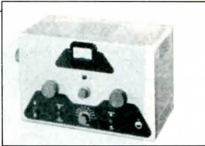
Figura 2. El DX-20 fue el primero de una serie de transmisores *Heathkit* de HF que aparecieron por los años cincuenta. Esta versión mejorada del modelo AT-1 tenía una potencia de 50 W funcionando exclusivamente en CW. ¿Válvulas? Sólo la 6DQ6 como final y la 6CL6 como excitadora. ¡Magnífico par!
