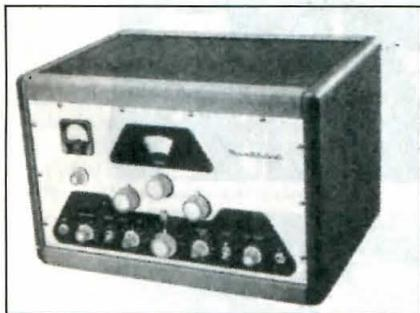
Figura 4. El «acorazado» de Heathkit para las bandas de HF: el legendario DX-100 que significó la realidad de un sueño de diéxista ya que sus 125 W de potencia de salida podían alcanzar literalmente cualquier parte del mundo.
