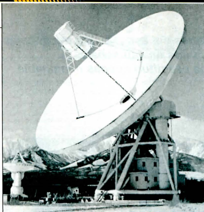
Observatorio Radioastronómico de Nobeyama (Japón). Disco paraboloide de 45 m de diámetro. Trabaja en la longitud de onda de 2 mm; a su izquierda, una de las parábolas de 10 m utilizadas en interferometría.
