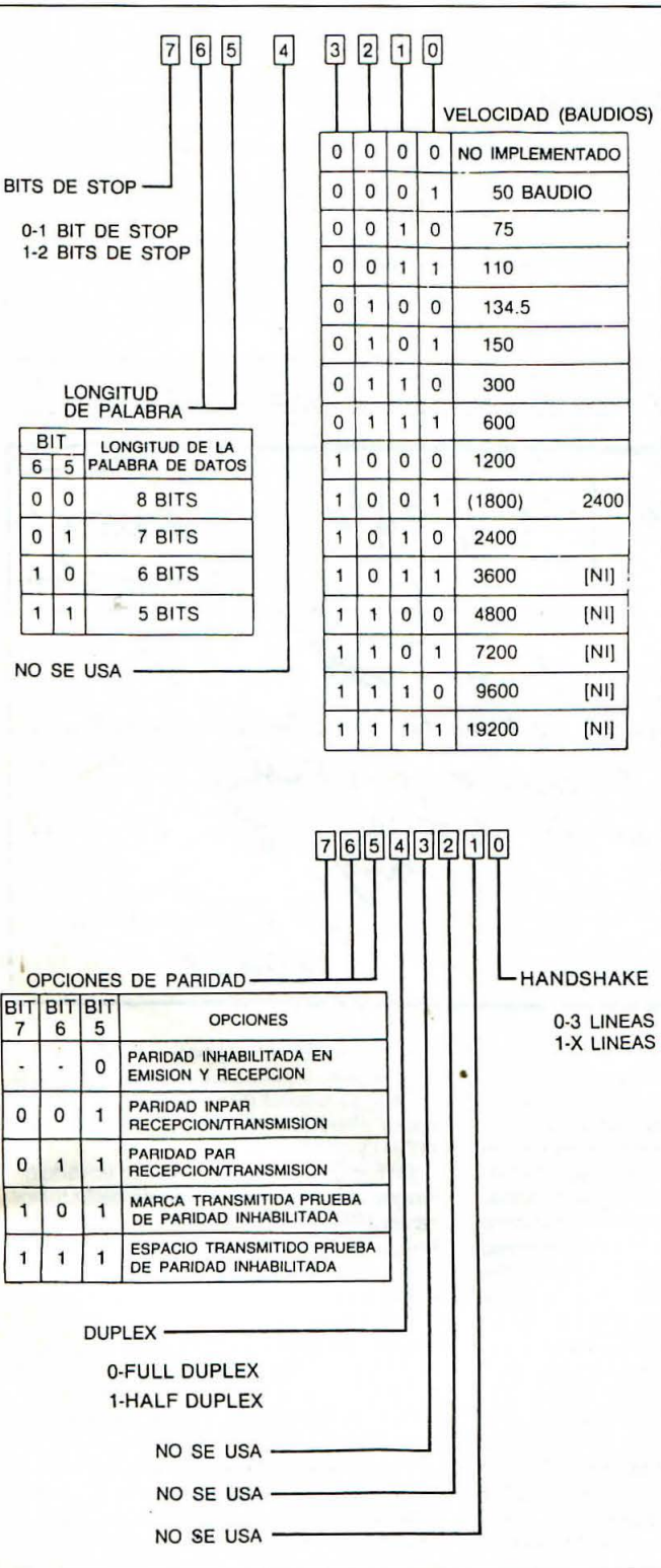
Figura 5. Dedución de los valores para el registro de control (tabla superior) y el registro de comando (tabla inferior). Reproducido de la «Guía de referencia del Commodore 64».
