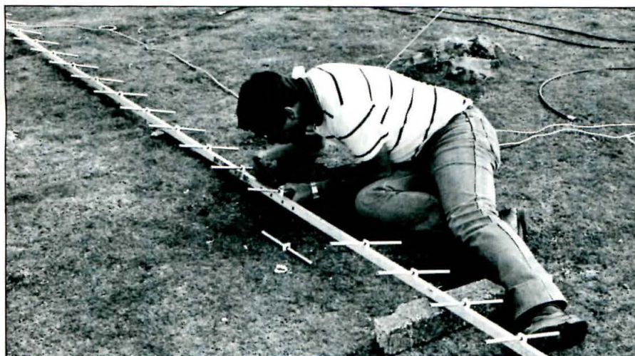
CT3BX y CT3DK operaron desde un QTH portable en la isla de Madeira. En la foto CT3BX repara su antena de 25 elementos para 70 cm, que es una modificación de la de 21 elementos F9FT de Tonna.
