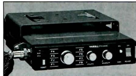
El aspecto exterior no cambia excepto en que el disipador es de una sola pieza de aluminio para mejor disipación de calor y el circuito ha sido cambiado por completo para permitir en una sola subbanda la cobertura completa de la banda VHF, manteniendo el ancho de banda usual de 10 MHz.
